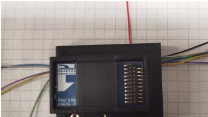
Mit zwei Senkscharungen M2x8 befestigen wir die Decoder-Halterung.
