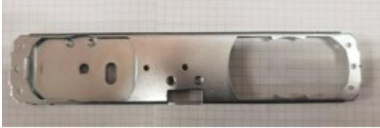
Danach bereite ich die Löcher vor, damit ich dann die Halterungen für den Decoder und den Kondensator montieren kann.
