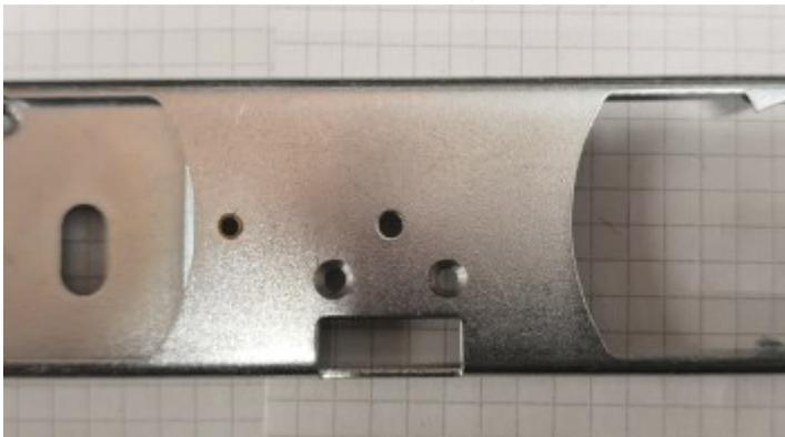
Bevor wir die Decoder-Halterung befestigen müssen wir das vordere Fahrgestell modifizieren. Ältere Loks haben immer eine Patina oder Oxidschicht auf den Flächen, welche in Verbindung mit Strom störend sind. Somit müssen wir hierfür was tun.
