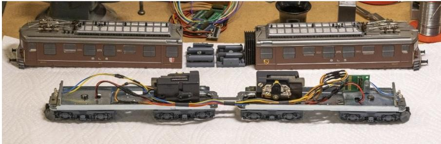
Zur Konstruktionszeit des Fahrzeuges gab es keine Verbindungen zwischen den beiden Lokhälften, beim Überbrummer mit 4 Motoren auch nicht, jede Hälfte hatte seine eigene Elektrik.
