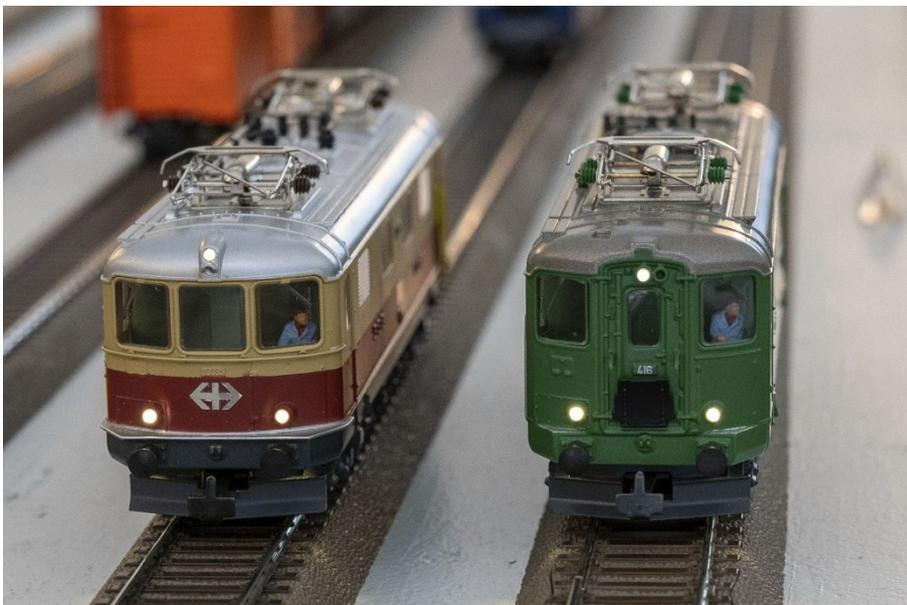
Ein weiteres Gussmuster ist fertig geworden. Die SBB Re 4/4 II erste Generation. Am Führerstand ist im Vergleich zu den BLS-Loks einiges mehr zu Feilen, auch müssen die Platinen ein wenig angepasst werden, es hat sehr wenig Platz.
