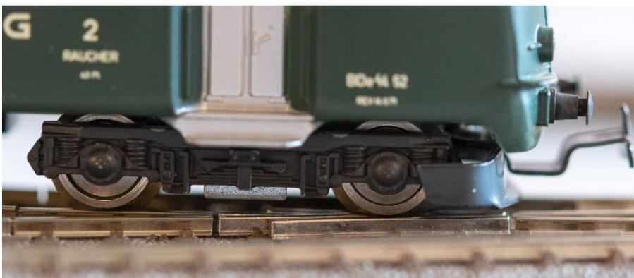
Also, neue 12 mm Räder vom neuen BDe 4/4, etwas passender Pantograf und komplett neue Elektrik mit Plux22 und Stütz-Elkos
