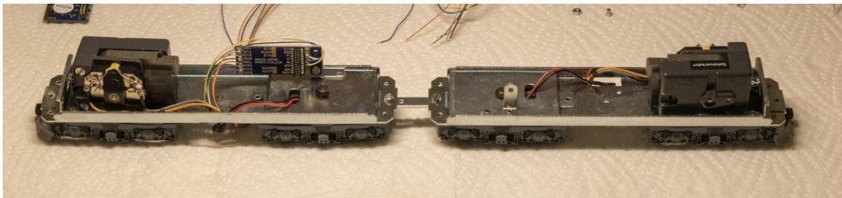
Die Plux Schnittstelle ist am bestehenden Stützwinkel montiert, dieser wurde mit einem zusätzlichen Gewinde versehen.
