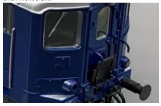
Wenn man auf die Lichter der Lok schaut, sieht man, dass der linke Lichtleiter fehlt. Dieser Fehler passiert schnell, wenn man den Lichtleiter herausnehmen will, da er leicht bricht – ein typischer Anfängerfehler bei Anpassungen an der Lok.
